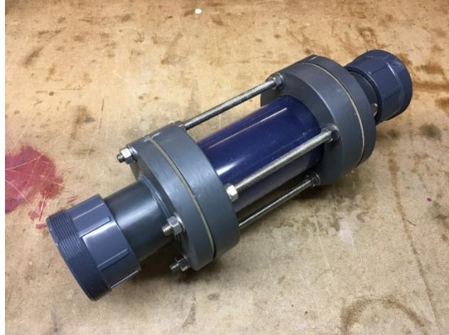
Poser la moitié du raccord avec le bouchon et verser le liquide nettoyant à l'intérieur de la cellule. Laisser agir quelques minutes, retirer le liquide nettoyant, vérifier l'état de la cellule et répéter l'opération si nécessaire.
