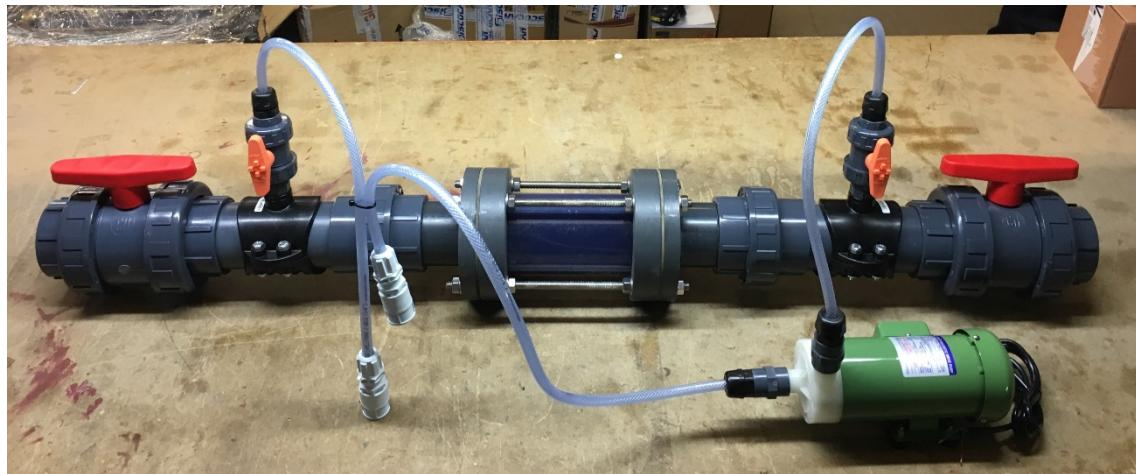
Una vez instalado, parar la filtración, cerrar las válvulas de entrada y salida de la célula
