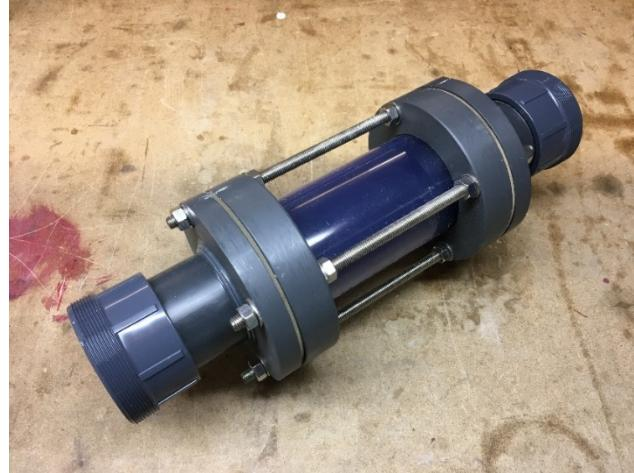
Colocar la mitad del enlace con el tapón e introducir el líquido limpiador dentro de la célula. Esperar unos minutos, retirar el líquido limpiador, mirar el estado de la célula y volver a realizar el procedimiento si es necesario.
